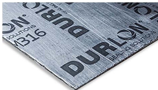
FGM316: 氧化惰性柔性石墨板材。多层 0.004”厚度 316 不锈钢钢板增强。适用于高压工况，方便切割为特别窄的密封面。
