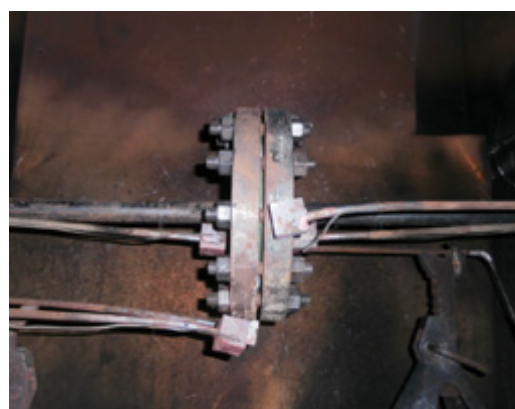
TYPE 1 法兰连接就绪，高温灼烧开始前
